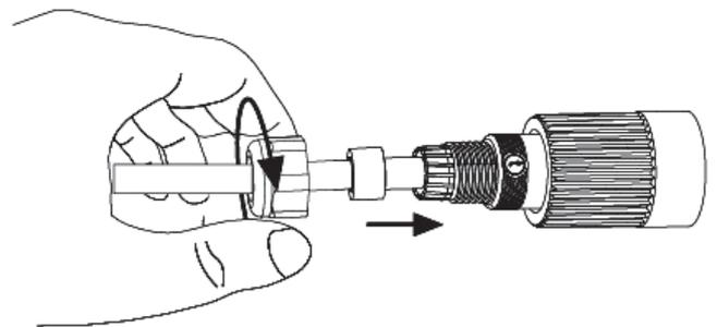
Ziehen Sie die Überwurfmutter mit einem entsprechenden Gabelschlüssel vorsichtig fest.
