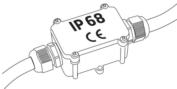
**Zwischen der beheizbaren Satellitenantenne und dem Stromnetz muss ein Differentialschalter sowie eine elektrische Schutzvorrichtung gegen elektrische Überlastung durch eine Elektrofachkraft installiert werden.**
