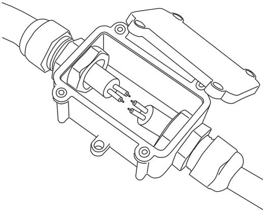
Dann schieben Sie die Einzelteile der Steckverbindung auf die Kabelenden wie in der Abbildung gezeigt.
