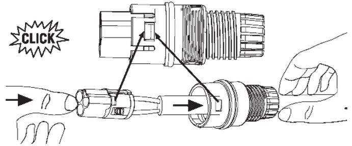
Verschrauben Sie nun die Überwurfmutter mit dem Steckergehäuse. Achten Sie darauf, dass die Dichtung während des Verschraubens am Steckergehäuse anliegt.
